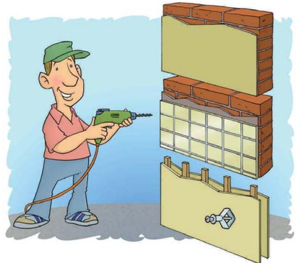
puede agrandar la perforación en el yeso, con el consiguiente desprendimiento del tarugo o trozos del tabique.
